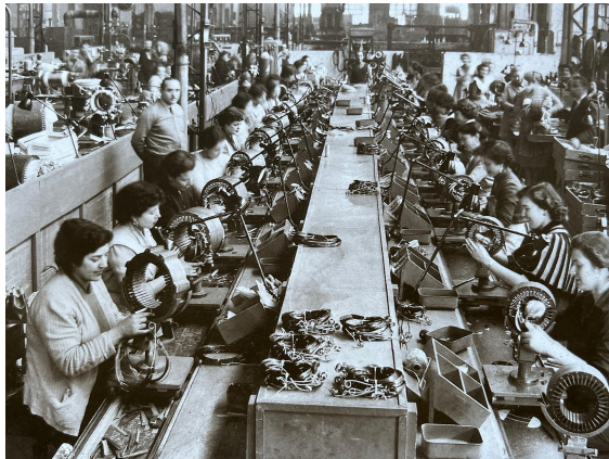
Imatge 8: Cadena de bobinaje d'estators de motor 1965.
