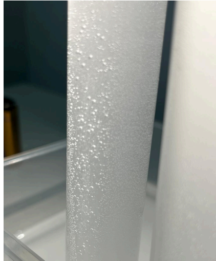
Figura 10. Tub amb oxigen: mostrar bombolles més grans, però menys nombroses. El volum de gas és menor que en el tub d'hidrogen. – Font pròpia.
