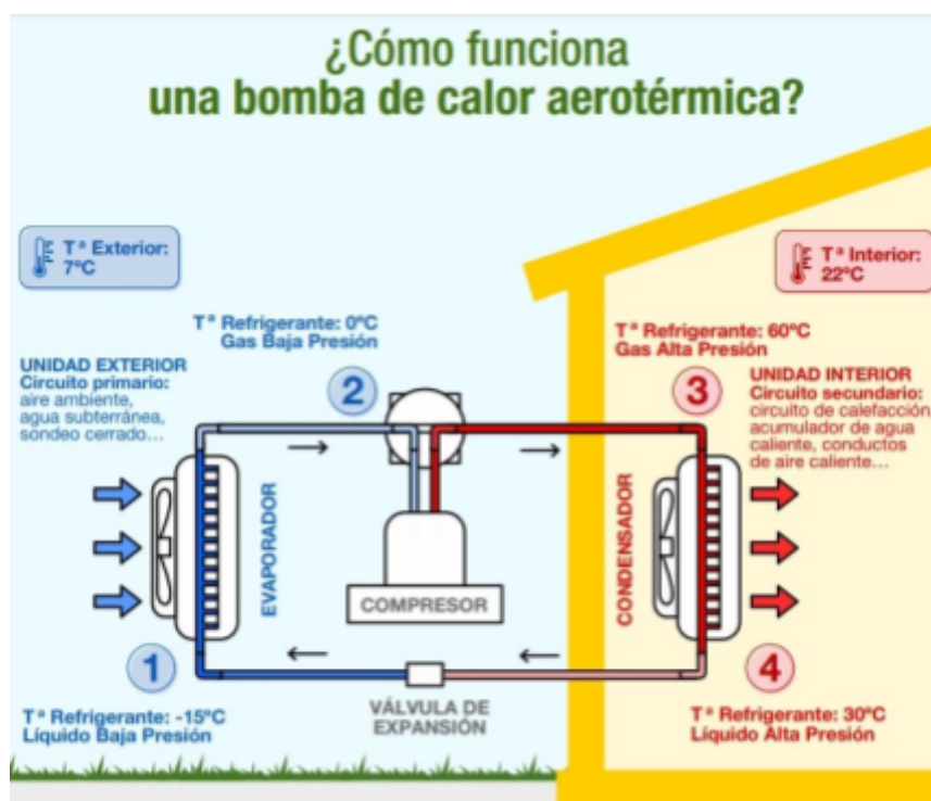
Figura 32. Com funciona l'aerotèrnia. De: FORTULUZ - Qué es la Aerotermia y cómo funciona para reducir la factura de la luz y el gas
