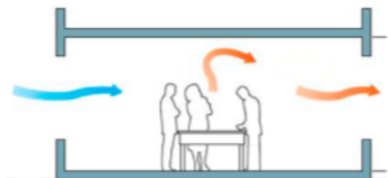
Figura 36. Ventilació creuada. De: Ventilación cruzada en el hogar y otros conceptos de ventilación natural 2023 - Por la Arq. Maria de la Paz Sevilla | HERMA Arquitectos (arquitecturasolorzano.mx)
