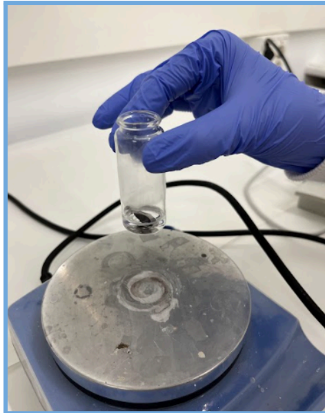
Figura 32. Escalfant el vial que conté la membrana de nanofil de Ferro en la solució de KOH sobre una placa escalfadora. Font: Elaboració pròpia.
