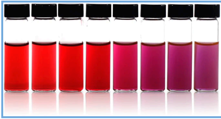
Figura 8. Nanopartícules d'or de diferents tamanyes en suspensió. Font: Nanocomposix
