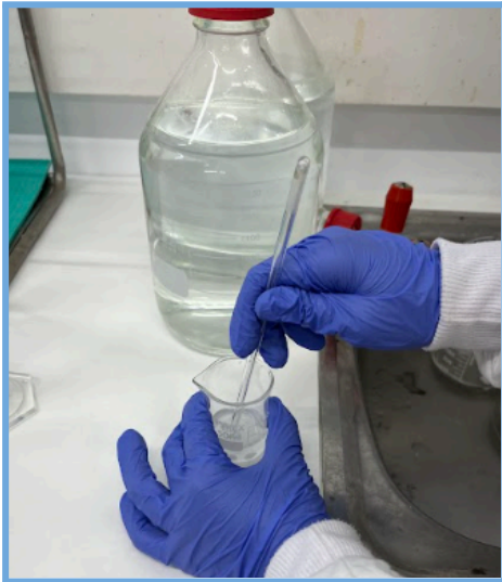
Figura 30. Remenant l'hidroxid de potassi amb una vareta de vidre. Font: Elaboració pròpia.
