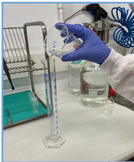
Figura 29. Mesurant els 25 mL d'aigua desionitzada en una proveta fins arribar a la línia d'enrassament. Font: Elaboració pròpia.
