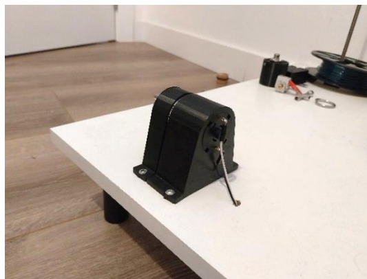
Figura 14: Mostra el motor subjectat amb els suports instal·lat sobre el tauler (16)
