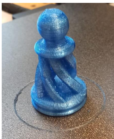
Figura 20: Primera impressió amb el filament reciclat (22)
