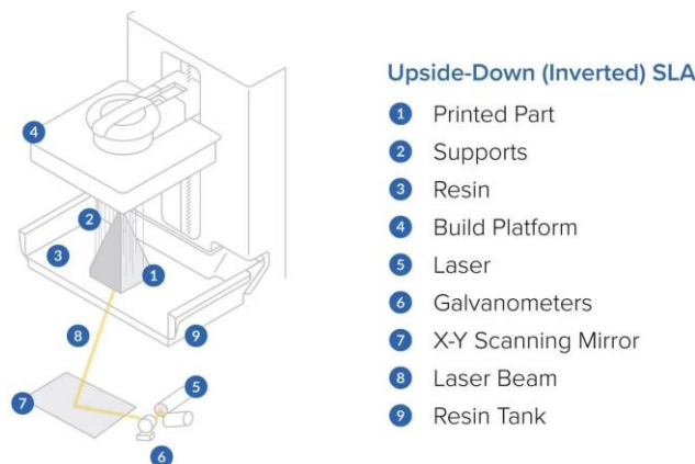
Figura 3: Components d'una impressora que funciona mitjançant la fotopolimerització. (3)
