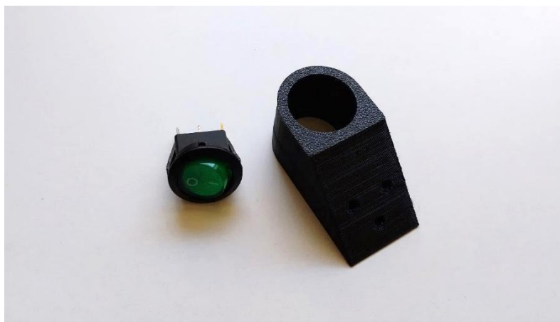
Figura 9: Mostra l'interruptor i el seu suport, imprès en 3D (11)
