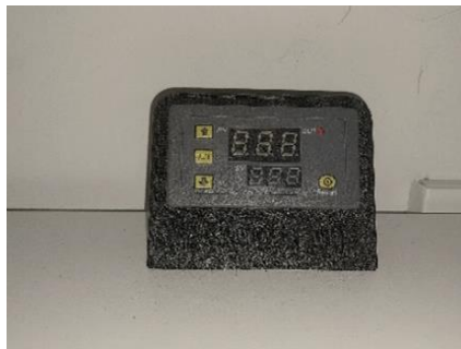
Figura 16: Mostra el Termocontrolador al tauler (18)
