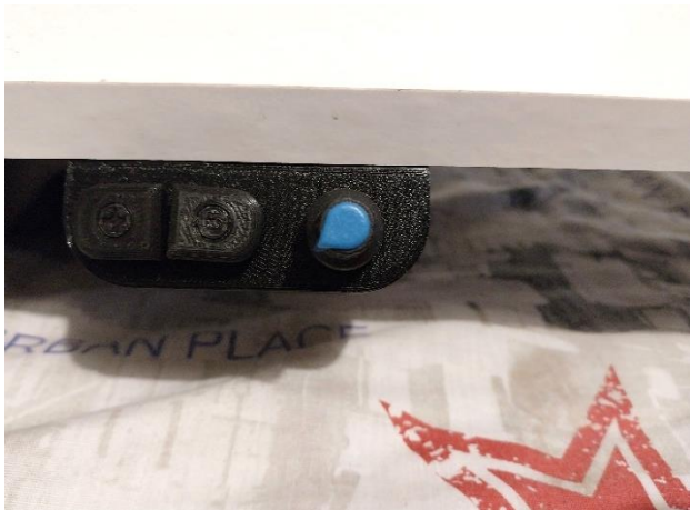
Figura 12: Mostra el potenciòmetre del regulador de voltatge subjectat al tauler (14)
