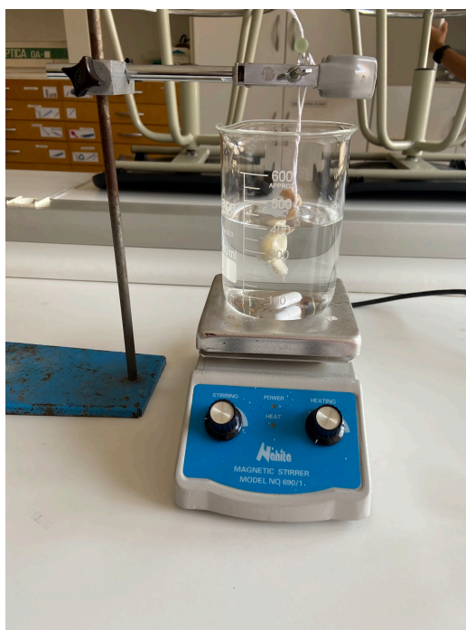
Figura 46: Un agitador magnètic amb un vas de precipitats amb una mosca, omplert amb 400 mL de solució tampó 7,4.
