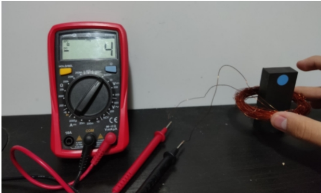
Figura 25: Imán atravesando la bobina
