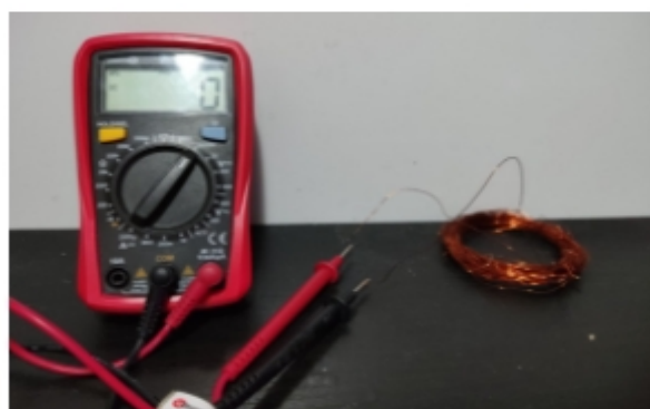
Figura 24: Bobina conectada al multímetro
