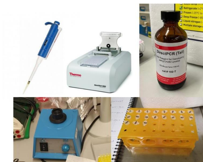
Figura 26: Material obtenció d'ADN: micropipeta, nanodrop, PCR-tail, agitador, reixeta amb vials.
