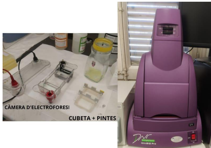
Figura 27: Material d'electroforesi: càmera d'electroforesi, cubeta amb pintes introduïdes i “chemidoc”.
