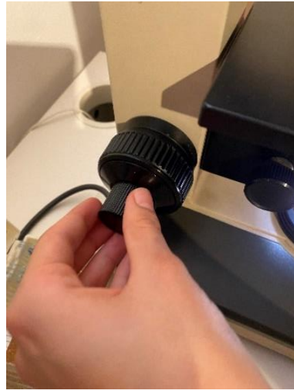
Figura 48 Enfocar i desenfocar amb el cargol micromètric ajuda a identificar-les perquè ens permet fixar-nos en molts detalls.
