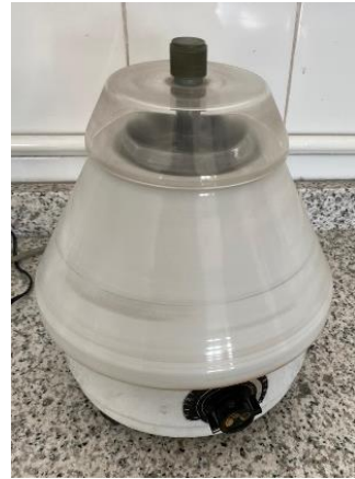
Figura 35 Centrifugadora que vaig utilitzar per al procés de neteja dels frústuls
