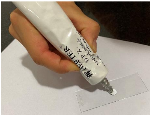
Figures 43 i 44 Posant una gota de DPX i el cobreobjectes amb l'ajuda d'una agulla emmanegada per a que no quedin bombolles.
