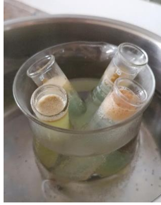
Figura 41 Pas 3: s'escalfen els tubs d'assaig en un bany d'aigua a 90 °C.
