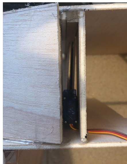
Vista des de dalt del motor i la porta col·locats.
