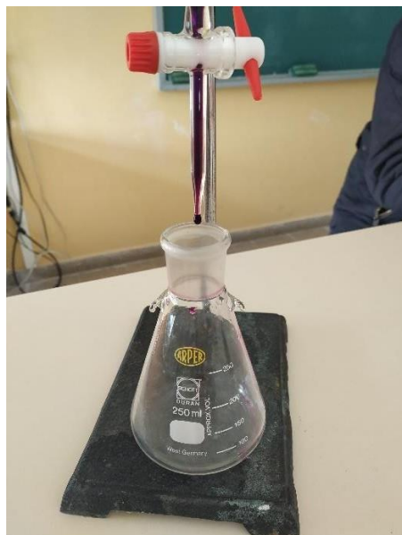
Figura 24: Aixeta de la bureta i caiguda gota a gota del \text{KMnO}_4 .
