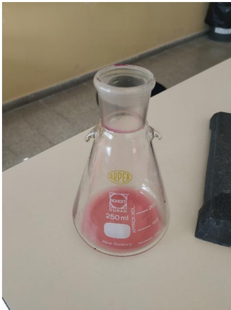
Figura 25: Valoració del ferro amb el permanganat de potassi finalitzada.
