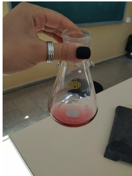
Figura 25: Valoració del ferro amb el permanganat de potassi finalitzada.
