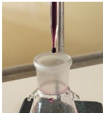
Figura 24: Aixeta de la bureta i caiguda gota a gota del \text{KMnO}_4 .
