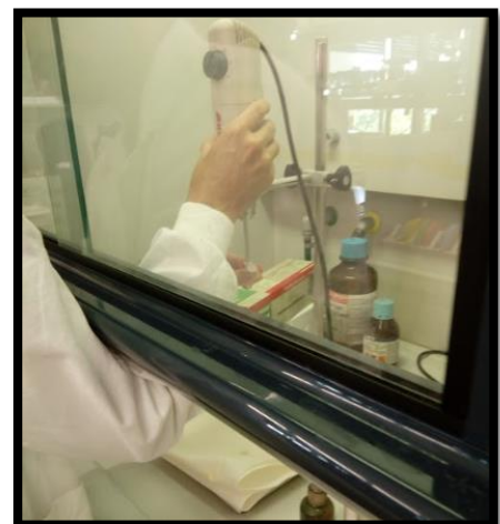
Figura 32: Polytron (usat per triturar les preparacions, fer-les líquides)
